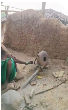
Fig. 5. New Fan for clay furnace
